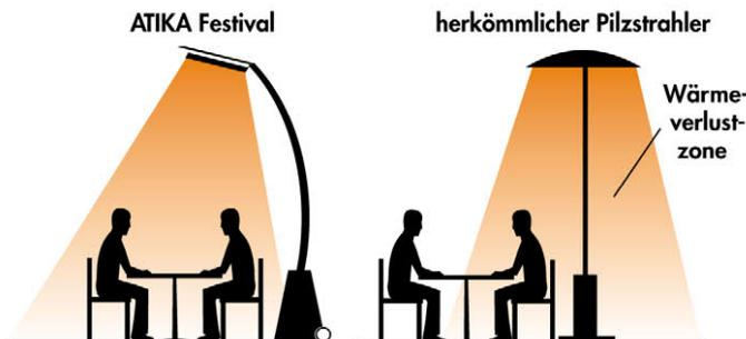
Kein Heizen ungewollter Flächen, wie bei der pilzförmigen Rundabstrahlung: Der Heizstrahler Festival strahlt nur dorthin, wo es gewünscht wird.
